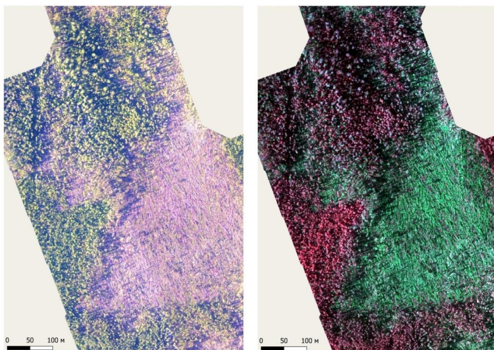
Рис. 1. Ортофотоплан ветровала в Киренском лесничестве: а) в естественных цветах (Red-Green-Blue); б) в искусственных цветах (NIR-Red-Green)
