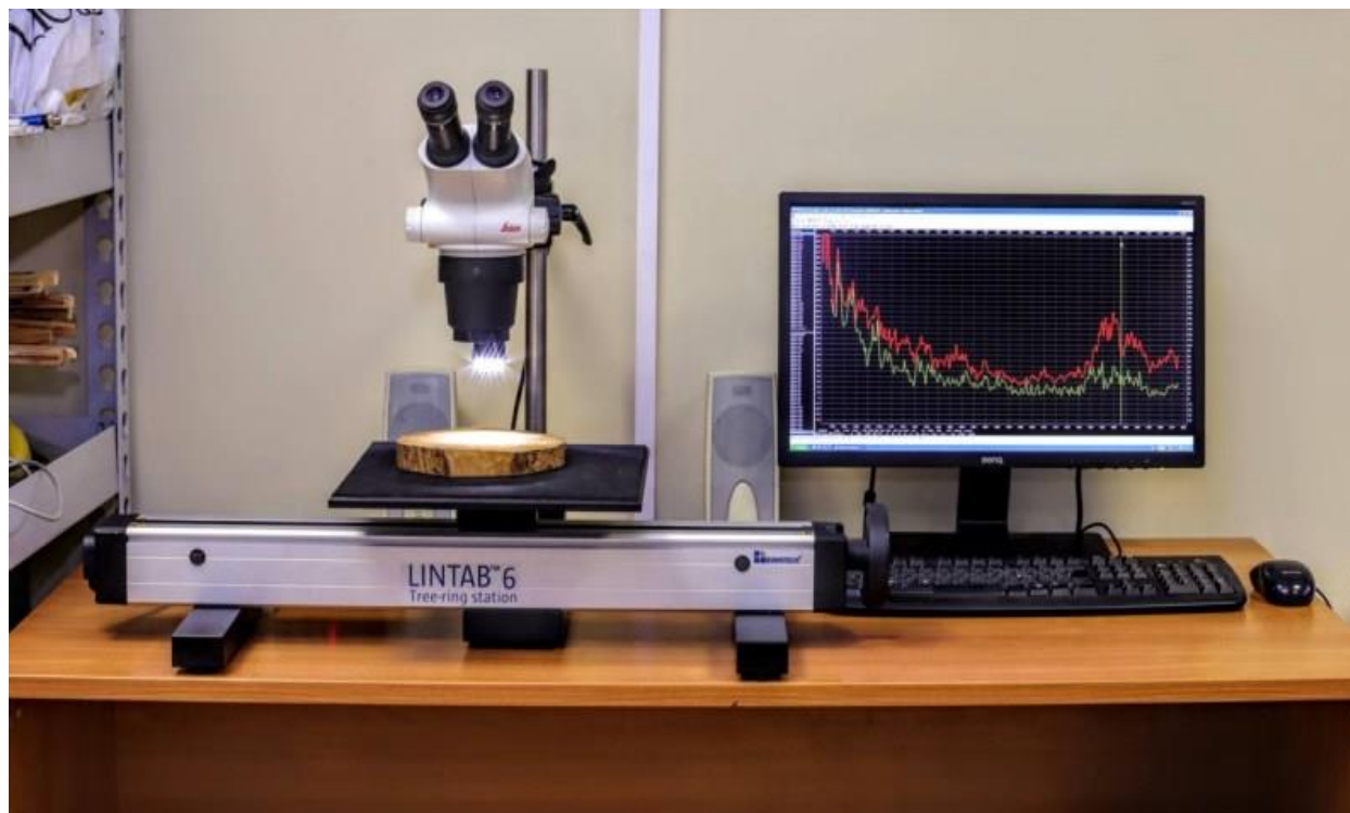
Рис. 2. Инструментальная обработка образцов на приборе Lintab 6
