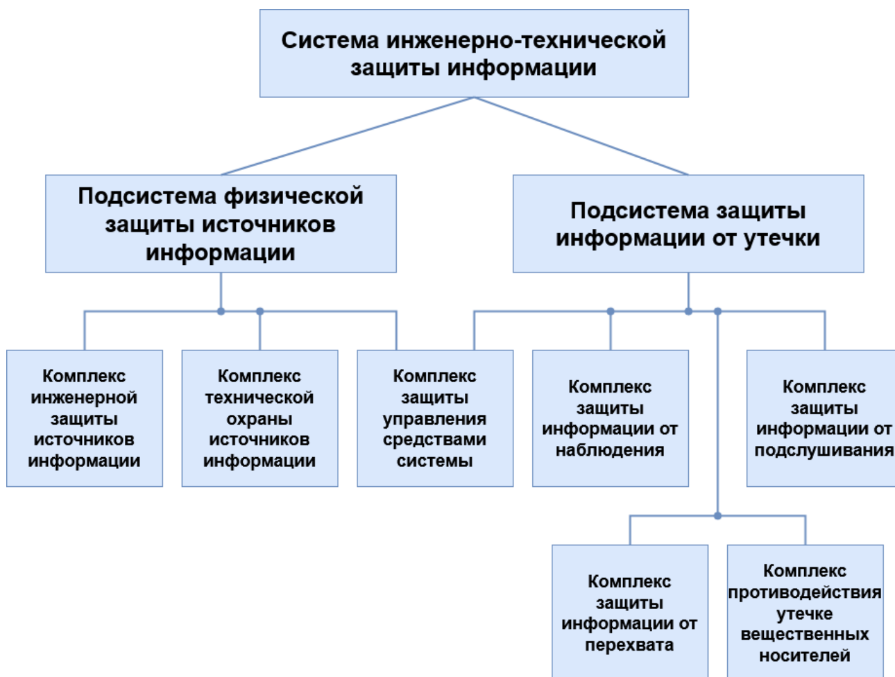
Рис. 7.29. Структура системы инженерно-технической защиты информации
