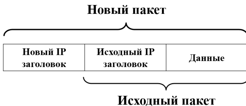
Рис. 4.35. Особенность технологии туннелирования
