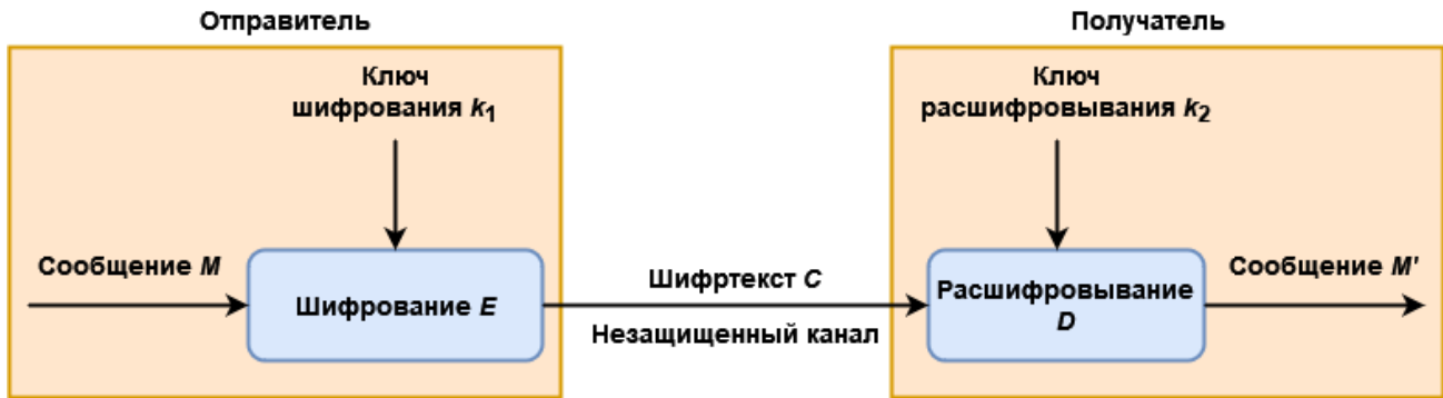
Рис. 5.1. Обобщенная схема криптосистемы шифрования
