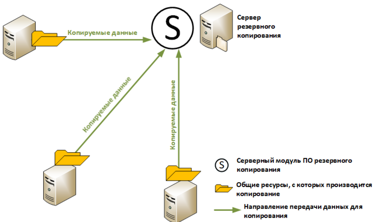
Рис. 4.49. Упрощенная централизованная схема резервного копирования
