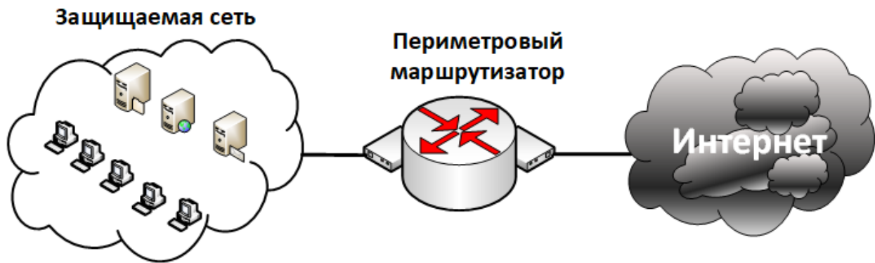
Рис. 4.21. МЭ на основе фильтрующего маршрутизатора
