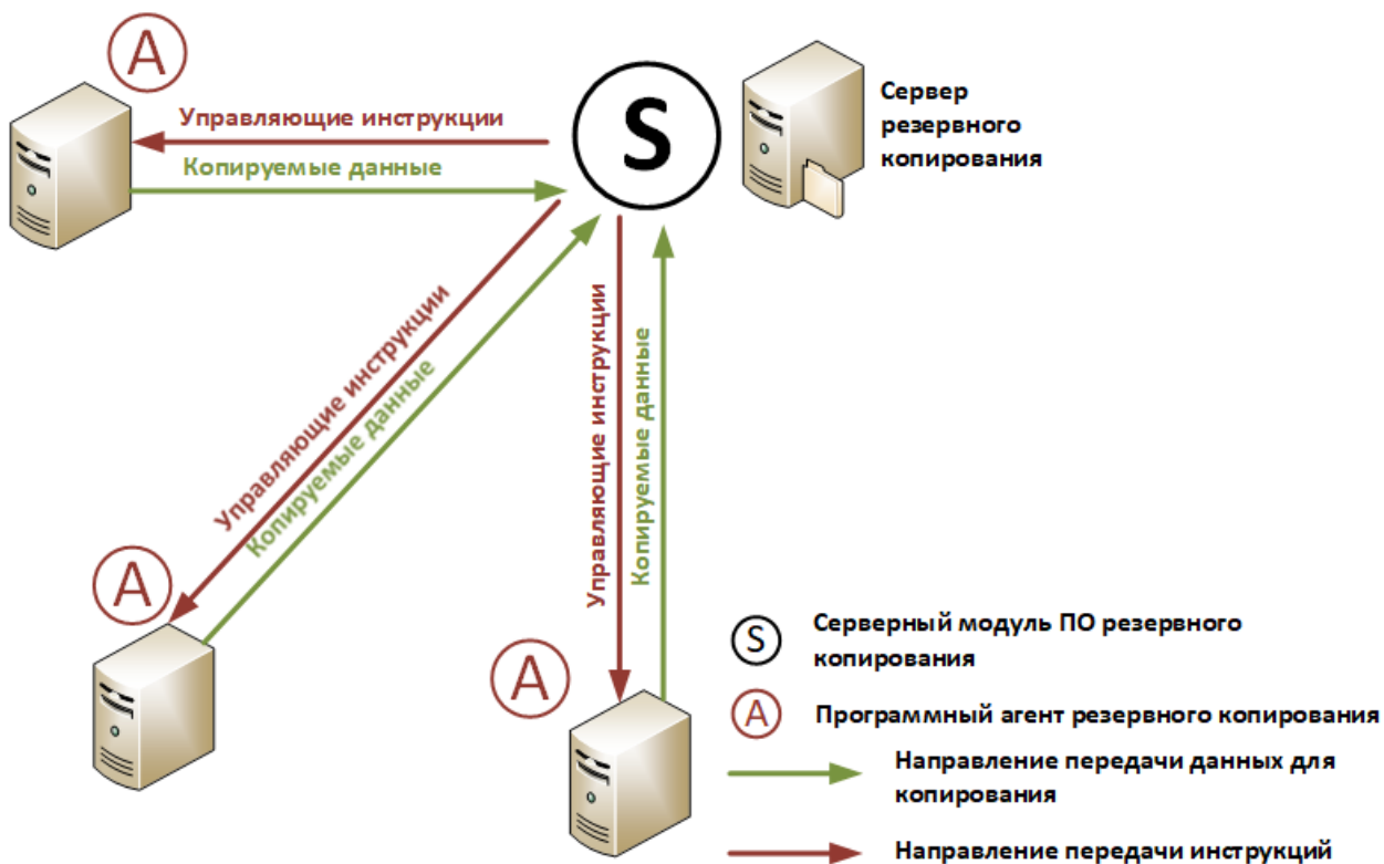
Рис. 4.48. Централизованная схема резервного копирования
