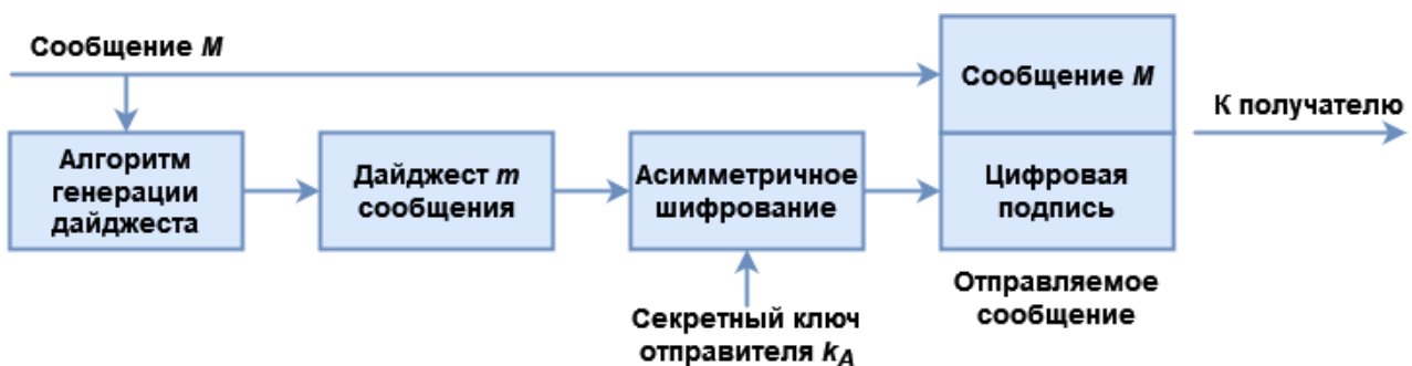
Рис. 5.19. Схема формирования электронной подписи
