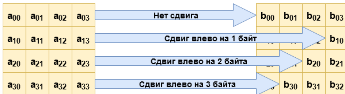
Рис. 5.14. Операция SR (сдвиг строк массива)
