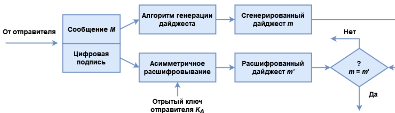
Рис. 5.20. Схема проверки электронной подписи
