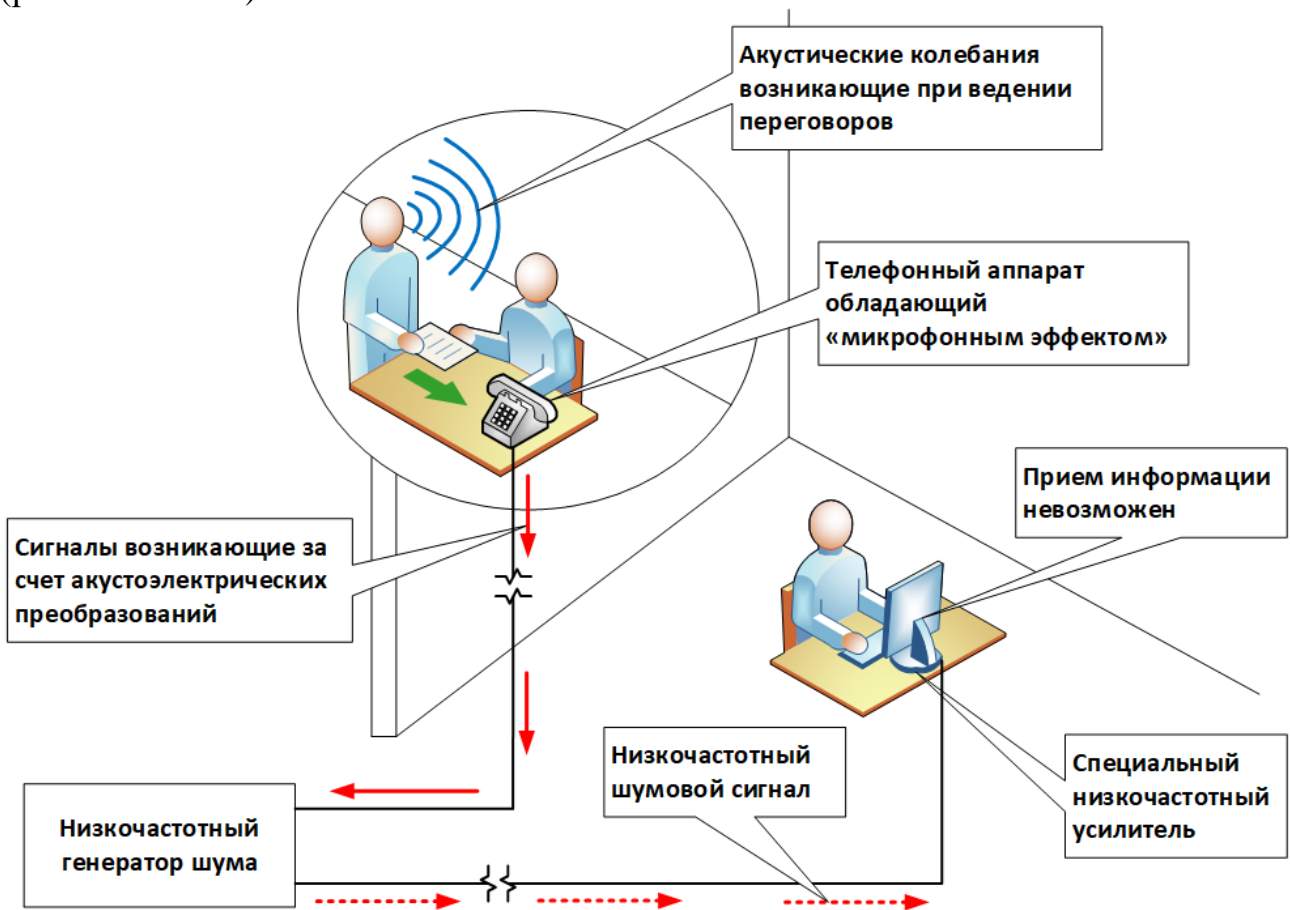
Рис. 7.26. Создание маскирующих помех в линиях связи
